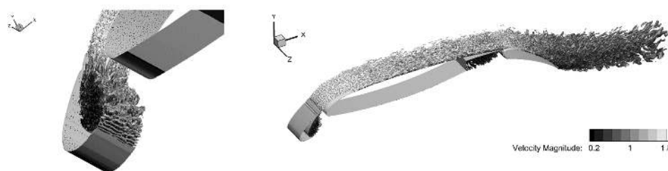
Рисунок 4.3. Поле завихренности вблизи сегмента крыла 30P30N. Изоповерхности Q -критерия, соответствующие значению 100, приведены в градациях серого по модулю скорости
