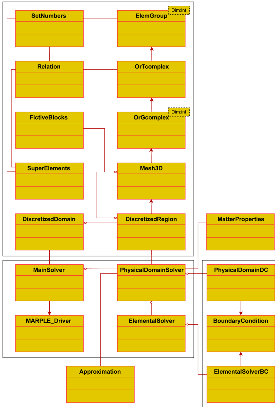
Рис. 3.1: Диаграмма классов UML: архитектура программного комплекса.
